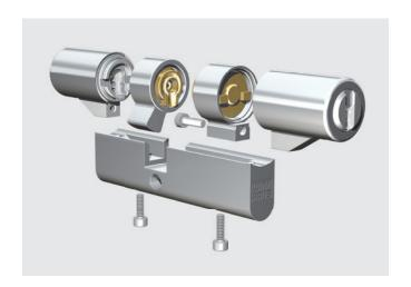
Der modulare Aufbau des keyTec X-tra Zylinders ermöglicht einen nachträglichen Umbau zur individuellen Anpassung an die Türstärke
